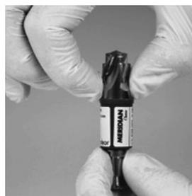
2. Deve ser possível pressionar o eixo do perfurador e a lâmina de corte, um contra o outro (consulte a figura)
