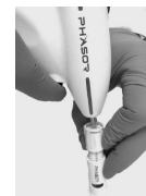
Figura 3: Ajustando o OSDS ou o DSE até que o comprimento desejado da broca seja exposto.
